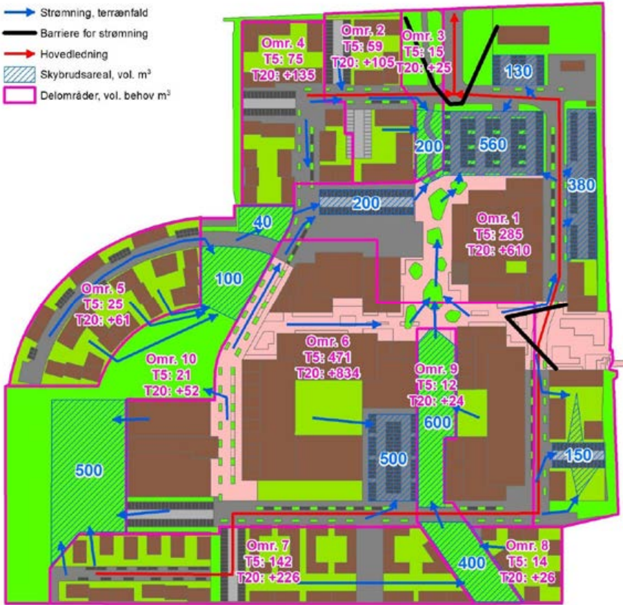
Figur 2. Volumenbehov (m³) for de enkelte delområder (T5 og T20) samt mulige arealer til placering af skybrudsvolumen. T20 volumen er angivet som ekstra nødvendigt volumen ud over T5-volumen. Desuden fremgår et principielt forslag til placering af hovedregnvandsledninger i projektområdet.
